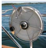
Вьюшка Такими швартовными вьюшками оснащают многие современные катера
